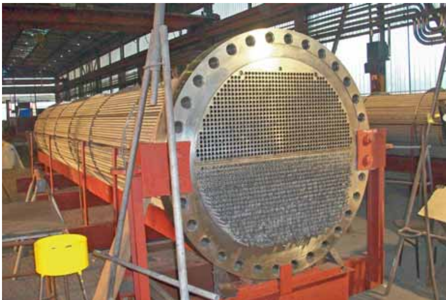
图2 换热器底板钻孔实现高达 25% 的金属去除率，加工过程中工件产生很大的热，需通过有效的冷却工艺排除。工件孔深是孔直径的 10 倍
