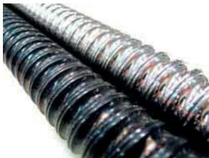
图 2 精整前后转向齿杆的钢球丝杆的局部图
