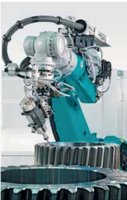
图 5 作为一种机床的机器人，用于对钢质大型齿轮的边角轮廓进行加工；加工作业采用 VHM 铣刀，机器人能为轮齿加工出均匀的最大为 5 mm 倒角
