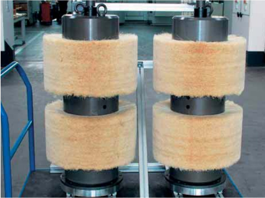
图 4 来源于墨西哥 Agaven 高地地区的纤维刷证明是一种最有效的技术方案
