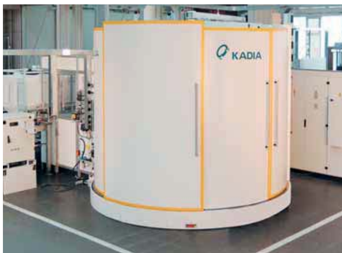
图 3 钢刷机床被设计为圆台机床, 它集去毛刺、去氧化皮和表面精整等三个工序于一身
