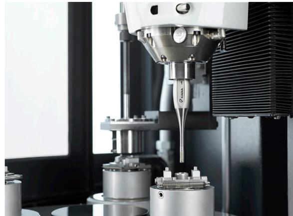
La bruñidora compacta E line es una máquina que ocupa solo 2.5 m<sup>2</sup> de superficie.
