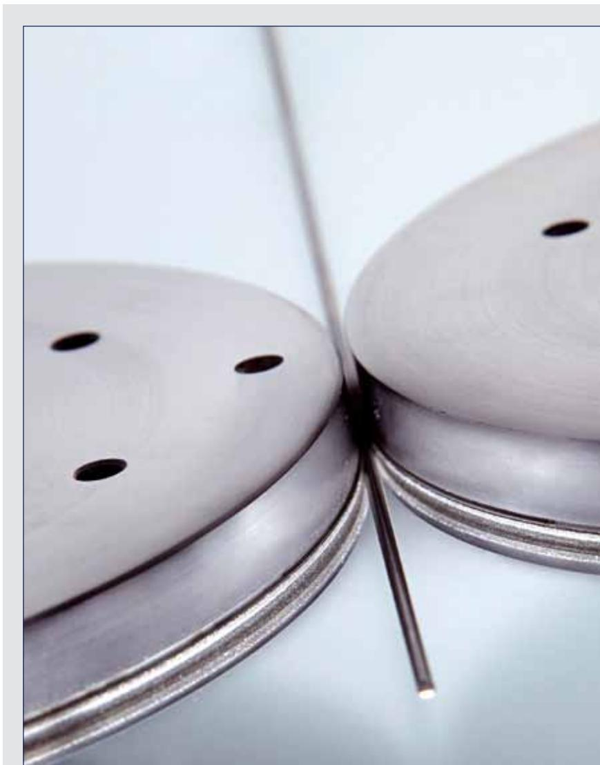
Zwei Transportrollen mit Diamantbeschichtung befördern Federdraht in eine Maschine, um ihn dort zu biegen. Die Rollen sorgen für einen exakten Vorschub, die Taktzeit beträgt nur wenige Sekunden. Ohne Diamantbeschichtung wären hohe Kräfte notwendig, die den Draht deformieren würden.
