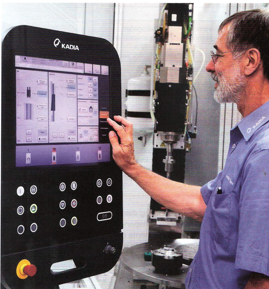
Bild 1: Das Bedienpanel der HMC100-Steuerung bietet einen hohen Bedienungskomfort für sämtliche bekannten Hon- und Messverfahren. Grafiken sorgen für Transparenz
