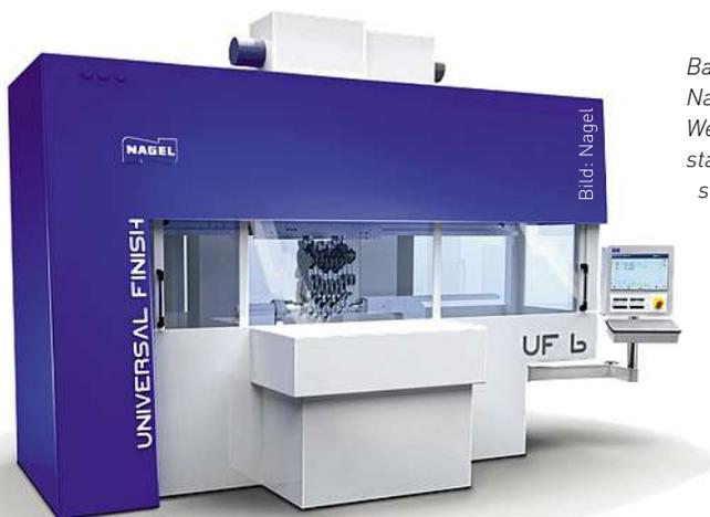
*Bandfinishmaschine der Nagel Maschinen- und Werkzeugfabrik. Dank standardisierter Schnittstellen sind sowohl konventionelle Schalenwerkzeuge wie auch D-Flex-Werkzeuge verwendbar.*
