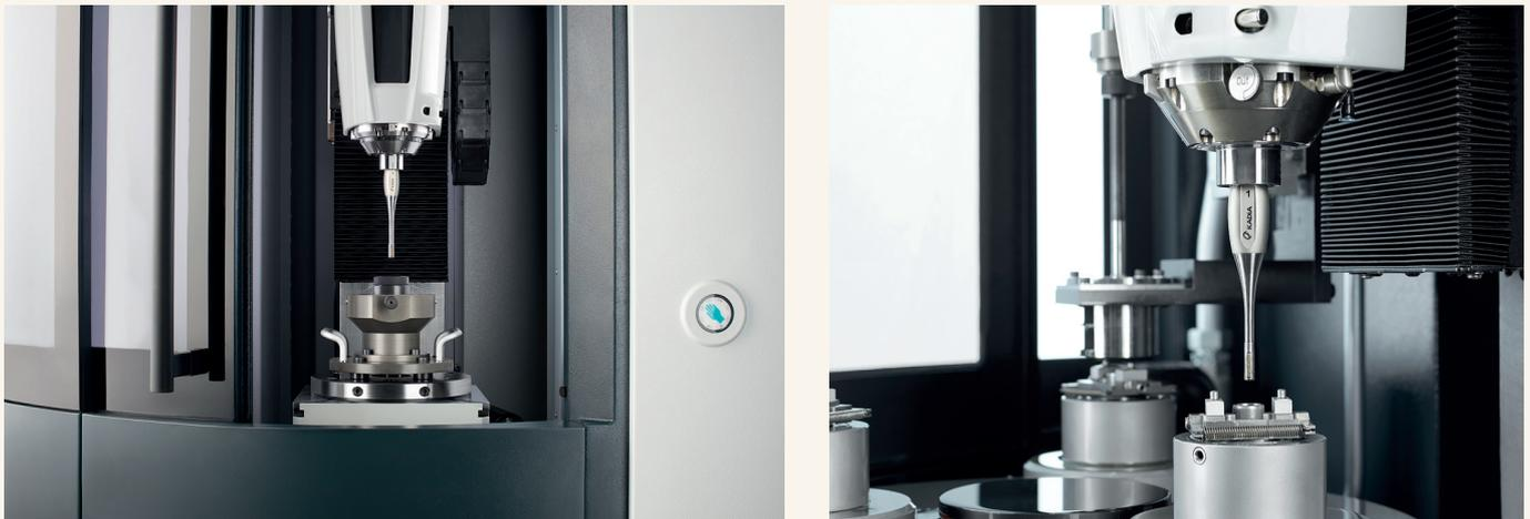
Bild 3a+b: Die E line lässt sich mit Festtisch (li.) oder Rundschalttisch mit bis zu drei Arbeitsstationen ausrüsten
