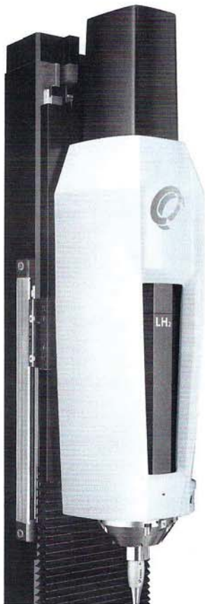
Bild 1: Klein aber fein. Die LH-Honspindel zeichnet ein kompaktes Design aus. Kompakt bedeutet kleine zu bewegende Massen und geringer Energiebedarf
