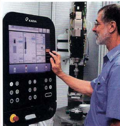
Bild: Mit der HMC100-Maschinensteuerung holt der Bediener das Maximum aus seinen LH-Honspindeln heraus
