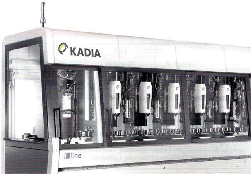
Bild 3: Auch mehrstufige Maschinen bleiben dank der schlanken LH-Honspindeln kompakte Aggregate
