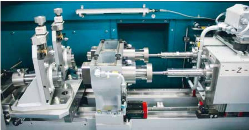
**Blick in die zweispindelige ML200:** die Vorrichtung mit Bohrbuchsenräger, hier mit Tauchhülsen. Für Bohrtiefen >200 mm rüstet der Anwender den Bohrbuchsenräger auf das Dichtgehäuseverfahren um. (© TBT)
