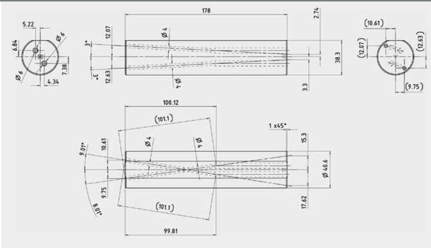
**Mögliche Variante eines zu bearbeitenden Werkstücks:** Schräge Kühlmittelbohrungen mit unterschiedlichem Abstand zur Achse treffen etwa in der Werkstückmitte auf parallel verlaufende, exzentrische Bohrungen. (© TBT)
