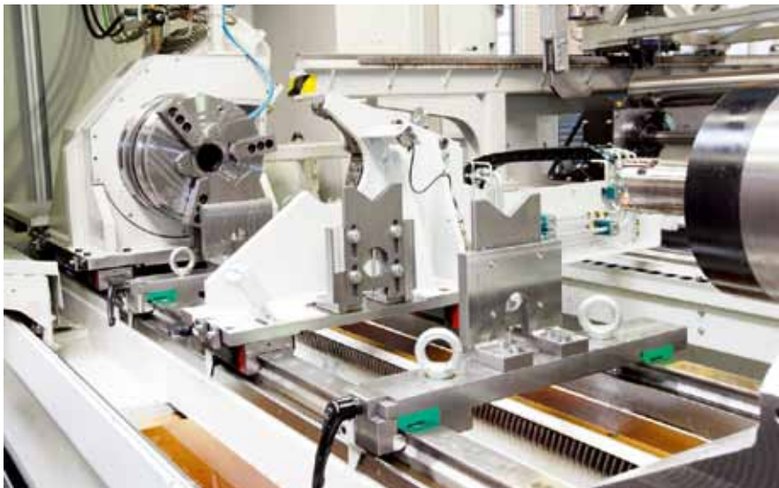
Der Arbeitsbereich der ML500 mit Dreibackenfutter und selbst zentrierender Lünette, ganz links der Reitstock mit Backenfutter.
