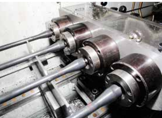
3 Bohren von Gesteinswerkzeugen auf einer vierspindligen Tiefbohrmaschine. Die Bohrtiefen betragen bis zu 1300 mm; gespannt wird mittels Spannkronen (Bild: TBT)
