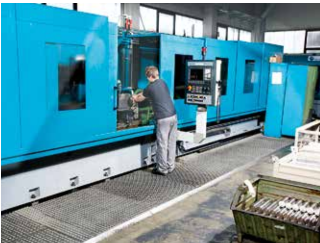
1 Tiefbohrmaschine von TBT mit 6 m Länge für Bohrungen bis 2700 mm Tiefe und 70 mm Durchmesser im Geschäftsbereich Lohnbohren am Standort Riederich (Bild: TBT)
