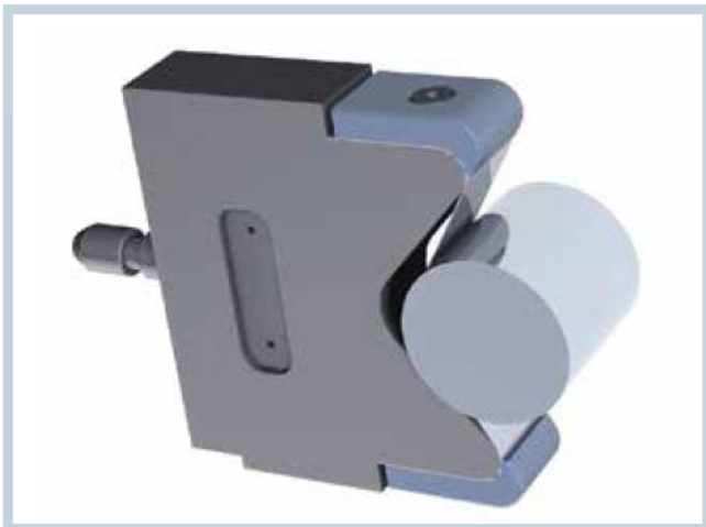
1 Das patentierte Bandfinishwerkzeug dFlex von Nagel wurde für die Bearbeitung von Kurbelwellenlagern entwickelt. Seine Besonderheit: Ein Federstahlband, durch Klemmelemente fixiert, bildet eine flexible Andruckschale für das Finishband (Bild: Nagel)
