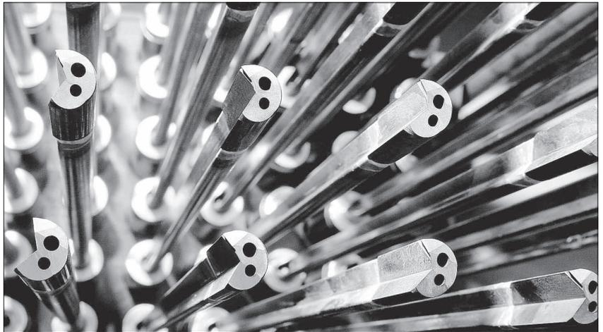
Einlippenbohrer der TBT zur Herstellung tiefer Bohrungen.
