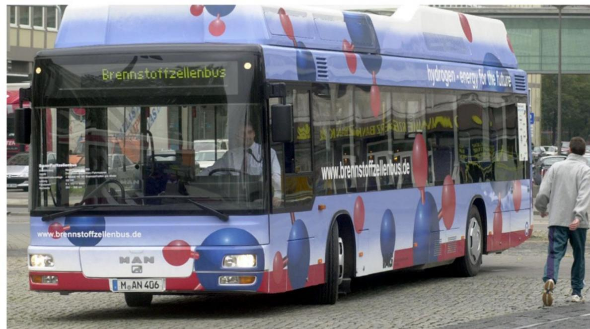
Prototyp eines Brennstoffzellen-Busses aus dem Jahr 2000. Die Umrüstung von Dieselmotoren auf Wasserstoff könnte eine Alternative sein.
